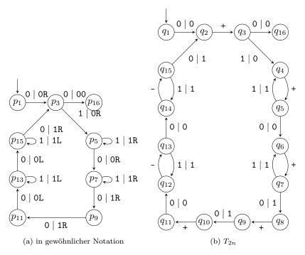
Abbildung 6: Turingmaschine zur Berechnung von f(n) = 2n
